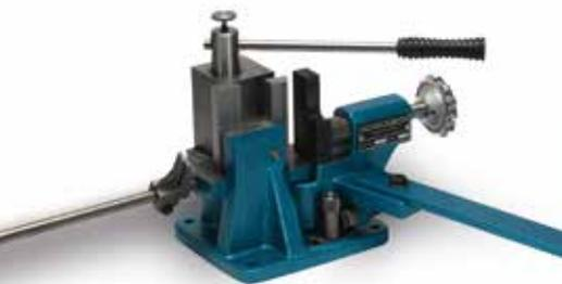
zum manuellen Biegen von ISOFLEXX® und massiven Flachschienen; Winkelanschlag stufenlos einstellbar von 0 - 120°; maximale Biegeleistung: Cu-Schienen 100 x 12 mm; aus bruchsicherem Sphäroguss
