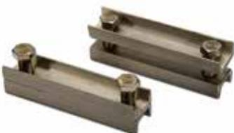
zur bohrungslosen Klemmverbindung von ISOFLEXX® mit Flachschiene in Längsrichtung, gewährleisten einen flächig konstanten Anpressdruck; Klemmweite 40 mm; aus Edelstahl, mit großer Biegefestigkeit; inkl. Schrauben und Muttern
