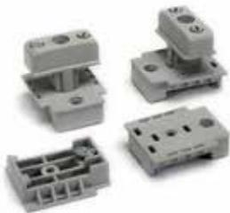
zur Montage von ISOFLEXX® an DIN Profilschiene 35 mm; aus halogenfreiem, selbstverlöschendem, glasfaserverstärktem Polyamid; Typ KSH 51 geeignet für Fixierung mit Kabelbinder
