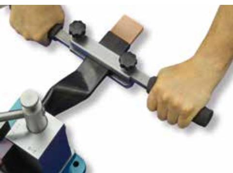
zum manuellen Verdrehen von ISOFLEXX® unter Verwendung des Biegewerkzeuges BV-100 oder einer anderen geeigneten Haltevorrichtung
